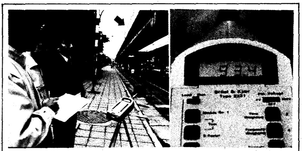
耗資鉅資，工務單位自認「漂亮」的基隆路高架橋隔音牆(前頭指處)，却被專家會診(左圖)為「設置地點」太不漂亮，且無法發揮降低噪音效果，尖峰時段出現的九十三點四分貝，更令人觸目驚心(右圖)。記者黃國育／攝影
