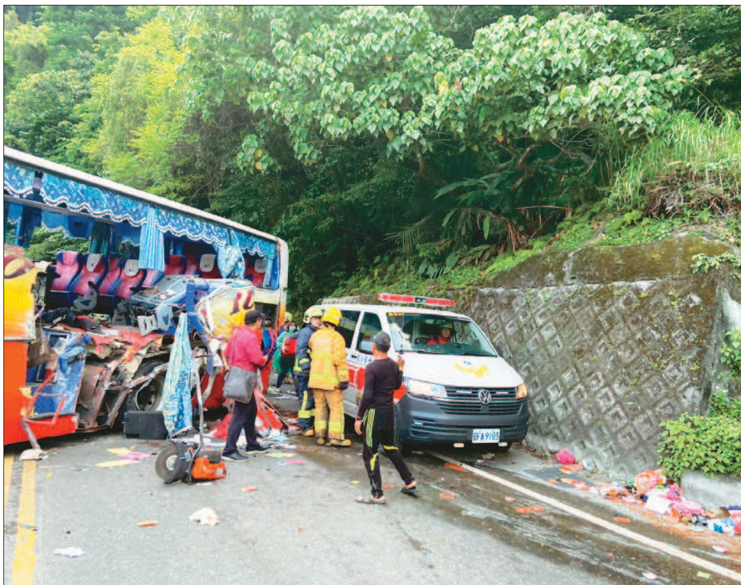
↑國家運輸安全調查委員會調查騰龍通運遊覽車撞蘇花公路山壁事故，發現座椅與車身脫離是車身結構系統性問題。(宜蘭消防局提供/資料照)
