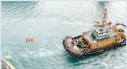
▲拖船作業時，以纜繩（箭頭處）拉牽船舶，引導至停泊位置。
