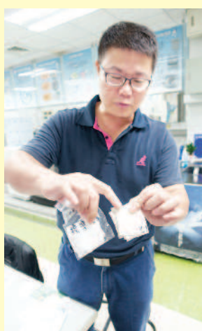
▲測試洗衣機洗淨力,用的不是一般衣物,而是標準汗染布,這樣洗淨力才有一致的衡量標準。圖為汗染布樣本。
