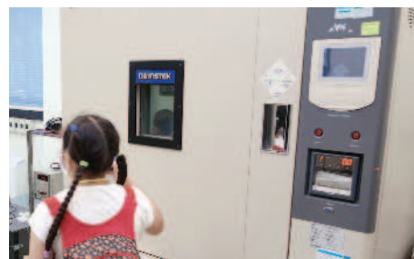
▲溫度會影響LED燈具壽命，因此會把它送進設定溫度攝氏五十度的恆溫箱一段時間，考驗燈具設計。
