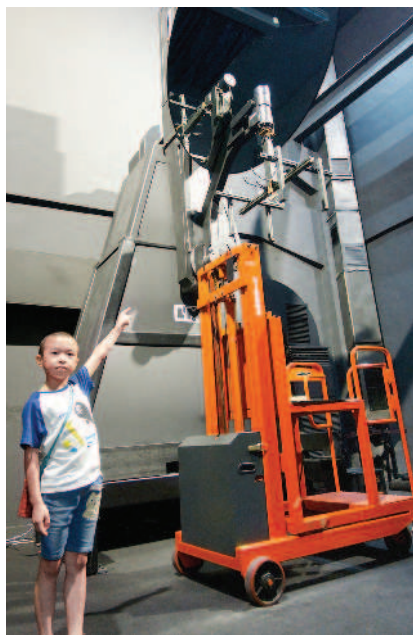
▲檢測光源配光曲線的場地很像攝影棚，檢測設備龐大。
