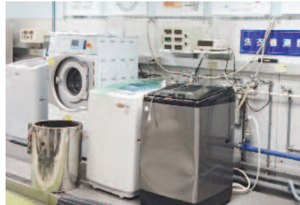
▲洗衣機測試。一臺洗衣機需要經過洗清、洗淨各三次檢測,做完完整檢測需要三個工作天。
