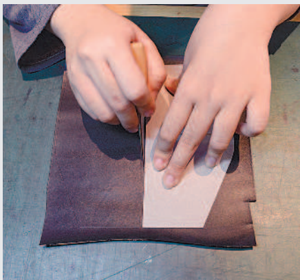
▶染色完成的皮革依照皮件的樣式，進行裁皮及貼合。
