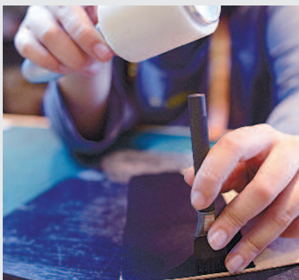
▶貼合的皮件還需要在縫合的位置打洞，再縫上縫線。
