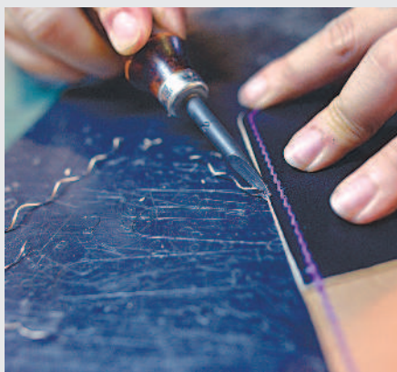
▶縫線後，要將皮件的邊緣作手工導角修飾。
