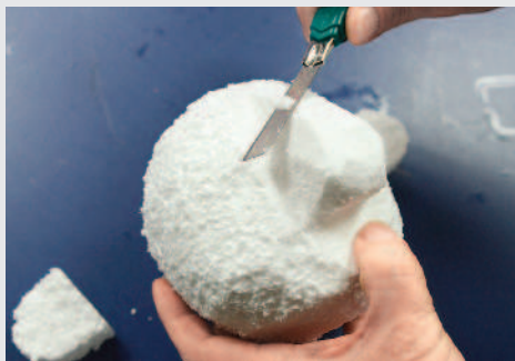
步驟二：用美工刀，依照設計圖切割雛形。
