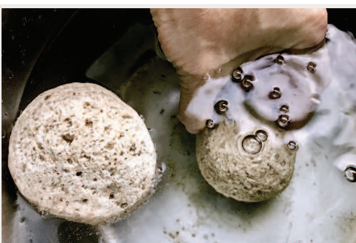
▲浮石能在水面浮起（左），用手壓入水中會冒出大量氣泡（右）。
