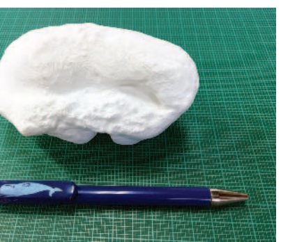
▲臺灣鯨魚耳骨複製品3D化後列印出來的複製品。攝於臺大古脊椎動物演化及多樣性實驗室。
