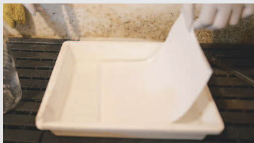
步驟四：浸泡硝酸銀，在全黑之處乾燥後即為感光相紙。
