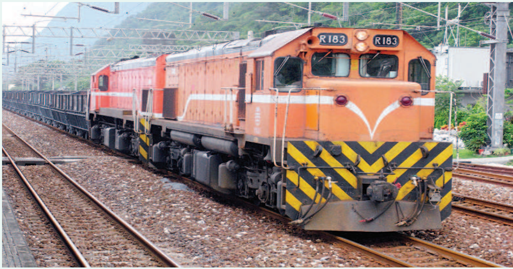
▲機車頭底下圓柱形的裝備，是儲放壓縮空氣的氣缸。
