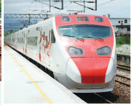
▶普悠瑪列車車廂高度受空氣彈簧控制。
