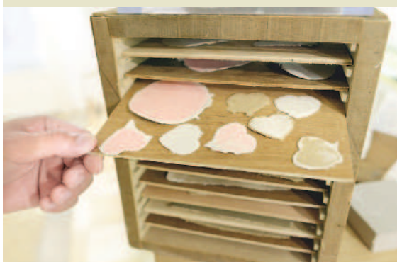
步驟五：把脫模後的紙分開放好，以利乾燥，再修整紙的邊緣。
