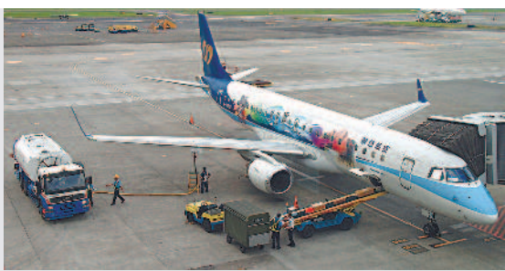
▲沒有燃油管路的機場，可使用油罐車為飛機加油。
