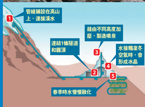
↑由鐵、竹子設置的管道，將冰川溪流的水收集起來，當管道壓力愈來愈大，水就會被噴出並結凍成冰。
