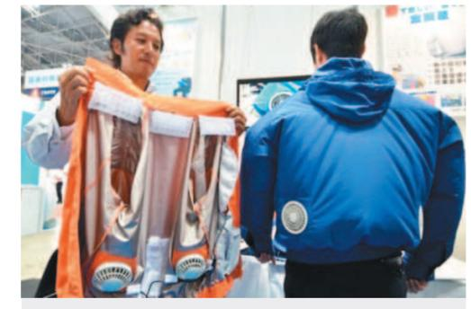
「風扇夾克」在日本「吹起」新流行，運用內嵌散熱風扇製造氣流、調節體溫，協助人們擺脫烈日下工作產生的黏膩不適。圖/法新社
