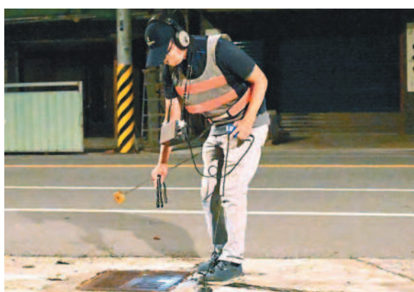
白天車流量大、噪音多，檢漏員通常在三更半夜出動。圖／台水提供
