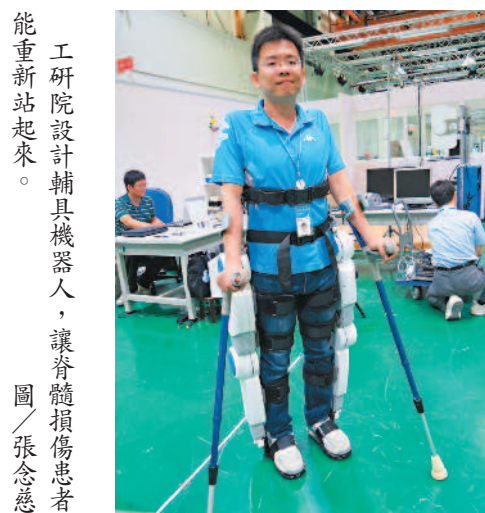
工研院設計輔具機器人，讓脊髓損傷患者能重新站起來。圖／張念慈
