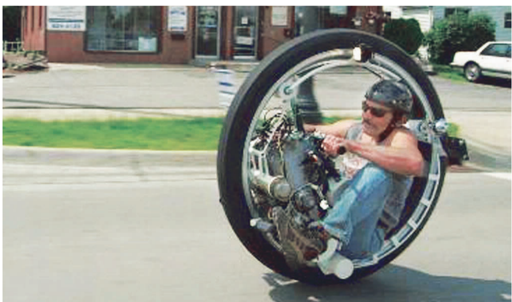
內車托摩輪單的造製設計他在坐林克麥·瑞凱為圖設位座車部這。遊巡區湖德立瓦的州根西密國美在，引擎車托摩地雪式冷水用採，內胎輪的吹四徑直在麥。內胎在曲捲兒胎像須必姿坐的駛駕。力馬十四有社聯美／圖。哩百一到達可速時車此，說林克
